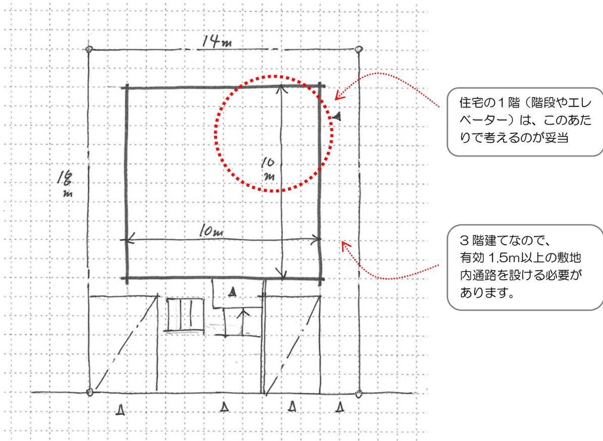
隣地境界線（北、西、東）については、2mもしくは1mの空きを確保します。ただし、住宅のアプローチとなる場合は、敷地内通路として有効1.5mの通路が必要となりますので、空き寸法は2mを確保するようにします。
