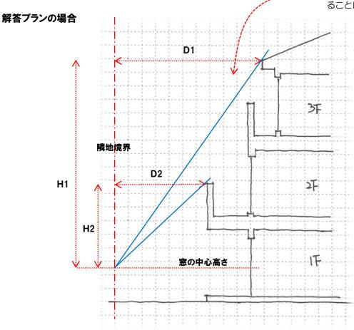
1 階の保育室に設けた窓の採光に有効な面積は D1/H1 と D2/H2 を比較して小さい方、つまり、D1/H1 が使用する**採光関係比率**となります。 住居系地域の場合、この D1/H1 に 6 を掛けて 1.4 を引きます。
